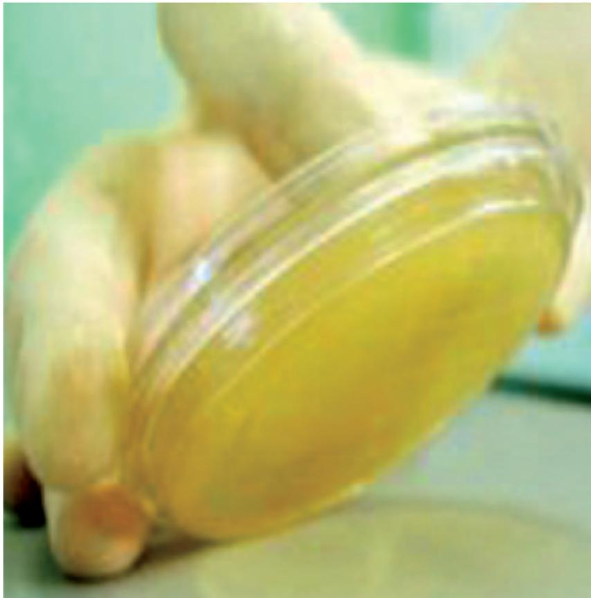
Figura 2 - Durante il prelievo la superficie convessa della piastra Rodac deve essere adesa alla superficie.
