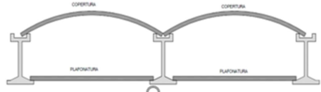
Si tratta in questo caso specifico di **CONTROSOFFITTO** in quanto la superficie interna in cemento – amianto **NON** è a diretto contatto con l’isolante
